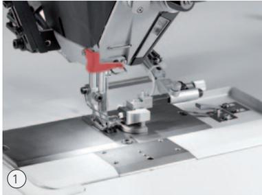
Echtzeitüberwachung der Fadenspannung (Stich für Stich) ①
