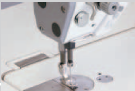
La nueva pinza-hilo controlada -909/14 garantiza siempre un comienzo limpio de la costura en la parte superior de la pieza de costura
