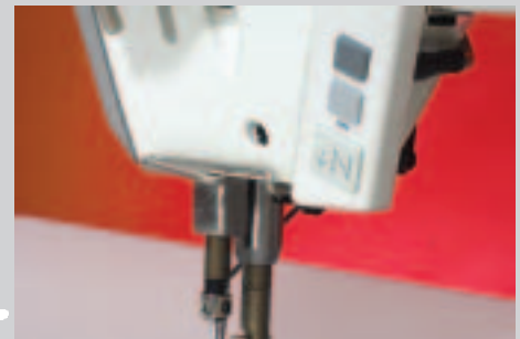
Nuevo pulsador triple en el área de trabajo de la operaria:
