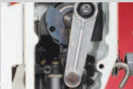
Una máquina para géneros gruesos y finos: carrera de la barra de aguja regulable
