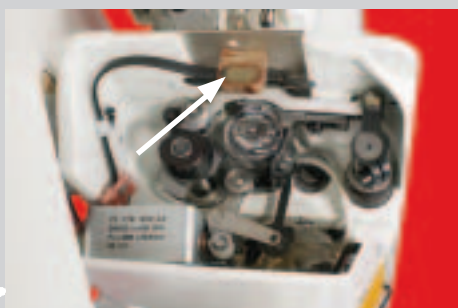
Contrôleur du fil de canette -926/06, avec détection du fil restant (en option)
