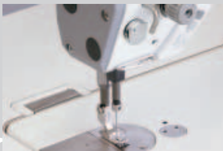
Le nouveau pince-fil -909/14, à commande électronique, est le garant d'un commencement toujours propre et net à l'endroit de l'ouvrage.
