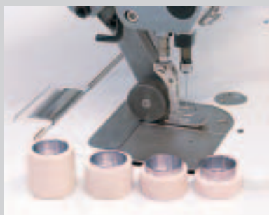
Changement simple sur différentes largeurs de puller
