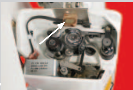
Spulenfadenüberwachung mit Resterkennung -926/06 (Option)
